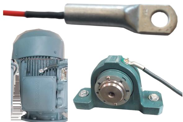
**HERS Model :** TEK-01 ile kullanıldığı gibi, bir PLC veya bir tehlike izleme sistemine bağlanabilir. Bağlantılar, normal sinyal kabloları ile uzatılabilir.
